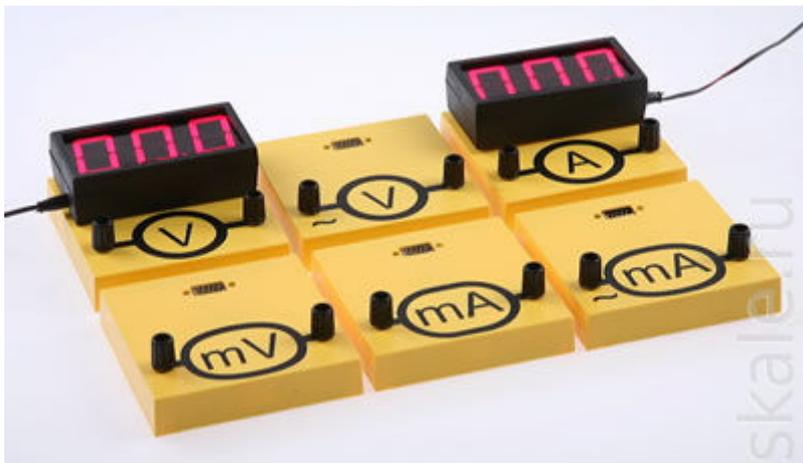
Учебное оборудование предназначено для измерения силы постоянного и переменного тока и напряжения при проведении демонстрационных экспериментов по всем темам раздела «Электродинамика».
