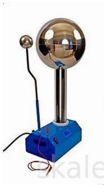
Прибор иллюстрирует перенос зарядов и создание высокого напряжения в опытах по электростатике. Принцип действия генератора основан на электризации движущейся диэлектрической ленты. Первый генератор был разработан американским физиком Робертом Ван де Граафом в 1929 году и позволял получать разность потенциалов до 80 киловольт.
